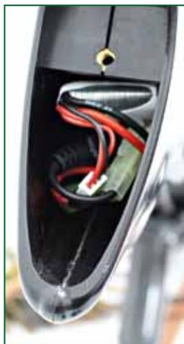
Ci-dessus, à droite. **Le fusible est à placer soi-même dans le circuit électrique, et le tout se place à l'arrière de la crosse.**
